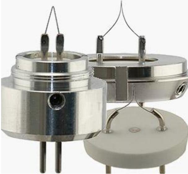
EB サイエンス社によって製造されたタングステンフィラメントは、走査電子顕微鏡および透過電子顕微鏡のすべての主要ブランドにおいて使用されています。カソードまたは電子エミッタとも呼ばれるこれらの高品質、高安定性のタングステン EM フィラメントは、オリジナルの装置製造業者の仕様を凌駕するように製造されています。これらの優れたカソードは、高品質のセラミックディスク、正確なサイズの接触ピンおよび高品位のタングステンフィラメントワイヤを使用して作られています。タングステンフィラメントの正しい形状を生成するために特別な工具が使用されています。すべての EB サイエンス社製タングステンフィラメントは、正確に組立てられ、フィラメントの応力を低減するために、高真空中でアニールされます。これにより、最適な安定性、最大の明るさ、より長い寿命でトータルのより低いランニングコストが実現されます。
